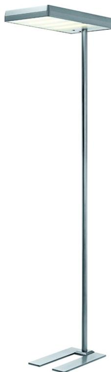
Lampadaire professionnel à LED à basse consommation pour le poste de travail, éclairage direct (67 %, 40 W) et indirect (33 %, 20 W), contrôle séparé de la lumière directe et indirecte, interrupteur sur la tête, diffuseur anti-éblouissement en PC, durée de vie moyenne des diodes env. 30'000 heures, ampoules LED 60 W, 110 - 240 V, 4800 lumens, 4000 Kelvin (blanc neutre).
