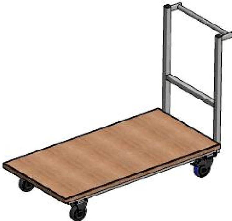
Châssis en tube acier rectangulaire,
