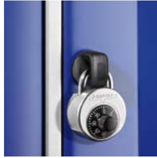
Sicherheits-Drehriegel: Ein Zerstören des Schließmechanismus durch Überdrehen ist nicht möglich, da der Schließzylinder erst mit Entfernen des Vorhangschlosses einrastet.
