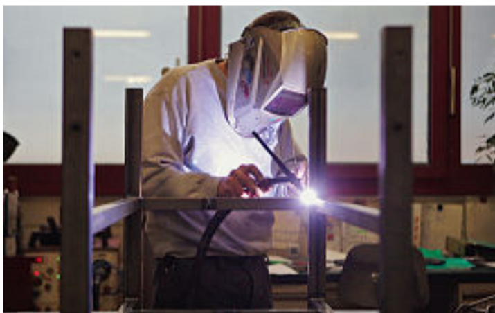
Roland Zaugg (Bild oben) stellt bewusst Mitarbeiter mit Behinderungen ein. Geschweisst wird sowohl von Hand als auch mit dem Schweissroboter, der zu den modernsten seiner Art gehört (Bilder unten). Stahl wird nicht lackiert, sondern mit Pulver besprüht und danach mit Hitze gehärtet. Lösungsmittel braucht es dazu keine, zudem wird Farbe gespart. Bilder: Olivier Gresset
